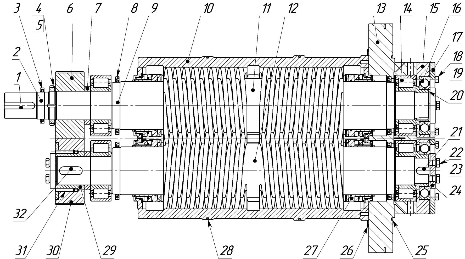
Рисунок Г.1 - Ремонтный комплект для насоса типа А8 2ВВ
