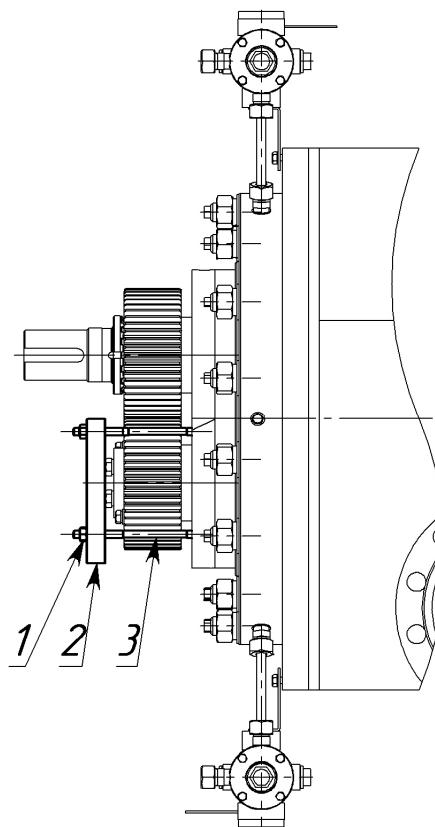
Рисунок 3 – Фиксация ротора ведомого от осевого перемещения
