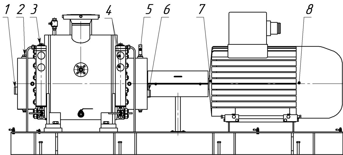
Рисунок 5 – Схема мест смазки
