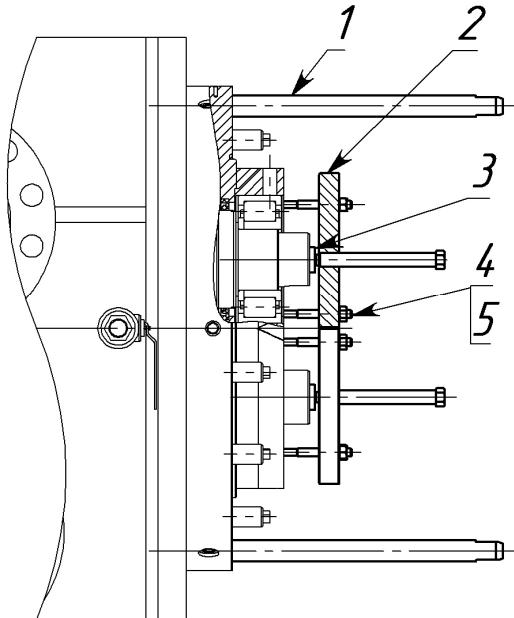
Рисунок 4 – Демонтаж подшипников насоса с неприводной стороны
