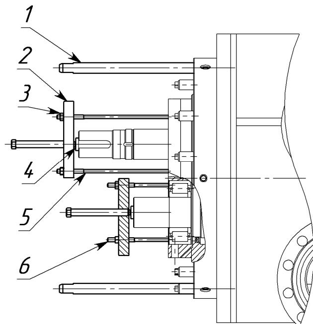
Рисунок 2 – Демонтаж подшипников насоса с приводной стороны
