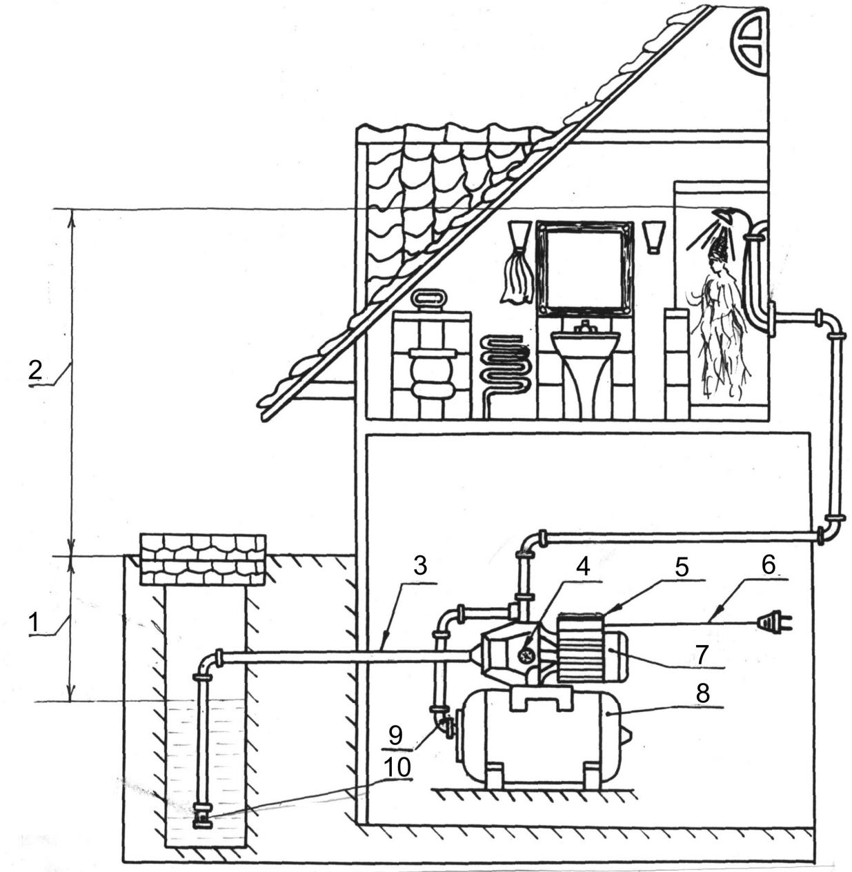
1. Допустимый уровень воды в колодце, определяемый как разность напора электронасоса и давления в напорном баке.
