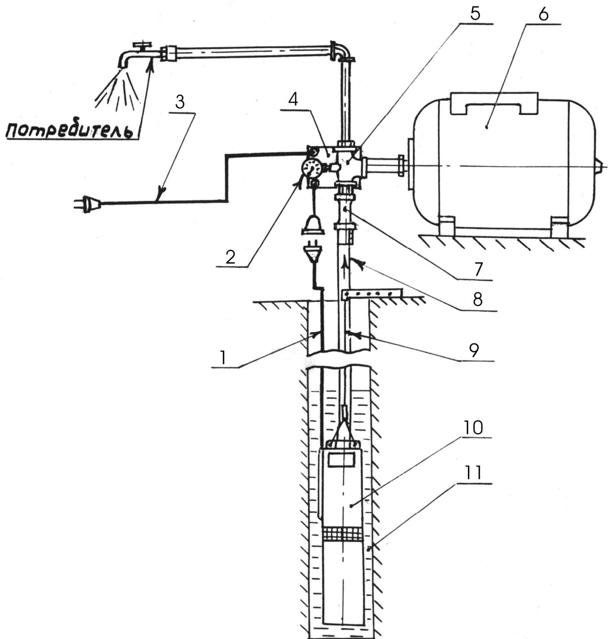
1- Шнур питания, 2-манометр, 3- шнур электропитания, 4- реле давления,
