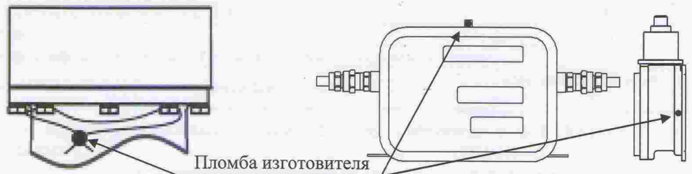
Рисунок 18 – Схема пломбировки ВП ЛУЧ-03 и ЛУЧ-04
