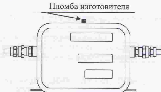
Рисунок 20 – Схема пломбировки КУП
