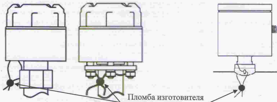
Рисунок 17 – Схема пломбировки ВП ЛУЧ-01 и ЛУЧ-02
